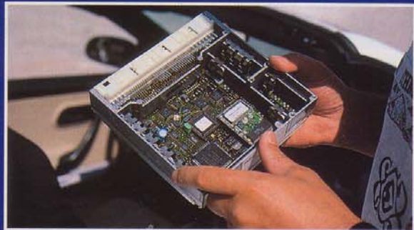
Das Gehirn des Motors: Die Elektronik regelt Zündung und Benzineinspritzung
