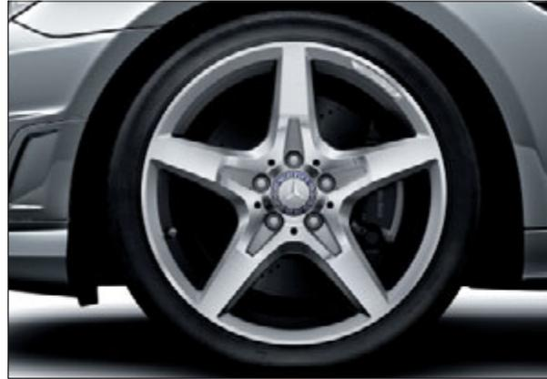
AMG Leichtmetallrad im 5-Speichen-Design, glanzgedreht, mit Bereifung 225/40 R 18 vorne und 245/35 R 18 hinten (Sport-Paket AMG, Code 782).
