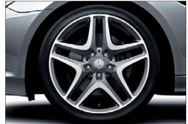
Leichtmetallrad im 5-Doppelspeichen-Design, in Palladiumsilber, glanzgedreht, bicolor, mit Bereifung 225/40 R 18 vorne und 245/35 R 18 hinten (Zubehörrad ab Werk).
