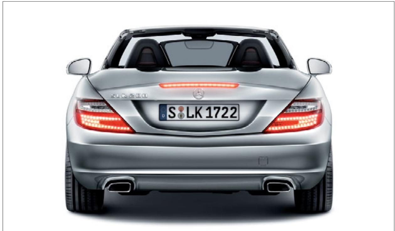
Das adaptive Bremslicht trägt zur Wahrnehmungssicherheit bei, indem der nachfolgende Verkehr durch blinkende Bremsleuchten gewarnt wird, sobald der Fahrer stark abbremst.
