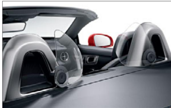
Das innovative Windschott AIRGUIDE minimiert Zugluft im Innenraum des geöffneten Fahrzeugs.
