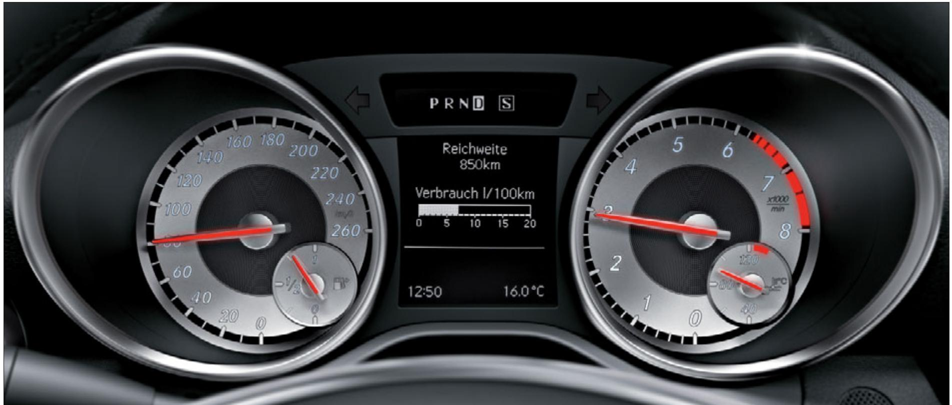
**Geschwindigkeitslimit-Assistent** (Option, Bestandteil des COMAND Online). Eine Frontscheibenkamera erfasst permanent die Umgebung des Autos, kann ausgeschilderte Tempolimits erkennen und dem Fahrer die erkannte Höchstgeschwindigkeit im Display anzeigen. So hat der Fahrer immer vor Augen, in welcher Tempozone er sich befindet. Dieser Komfort macht sich insbesondere auf Strecken mit Wechselverkehrszeichen oder bei Baustellen bemerkbar.
