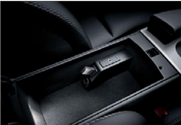
USB-Schnittstelle und Aux-in-Anschluss in der Mittelkonsole.
