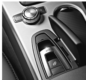
Dach-Bedieneinheit und zentrales Bedienelement
