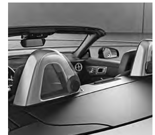
AIRGUIDE und Überrollbügel mit Einleger Aluminium eloxiert (283+B15)
