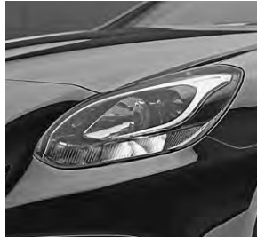
Hauptscheinwerfer in H7 Projektionstechnik mit integriertem Tagfahrlicht
